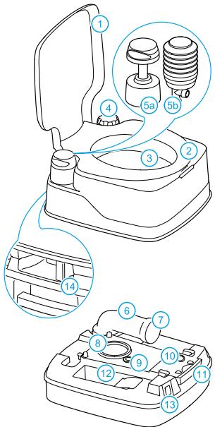
1 Крышка • 2 Сидение • 3 Унитаз • 4 Крышка водозаливной горловины • 5а Поршневой насос • 5б Сильфонный насос • 6 Сливной патрубок • 7 Заглушка сливной трубы • 8 Прокладка • 9 Уплотнение выпускса воздуха • 10 Кнопка выпуска воздуха • 11 Рукоятка задвижки • 12 Отсек для хранения жидкостей для туалета • 13 Индикатор бачка для стоков (в зависимости от модели) • 14 Защелка
